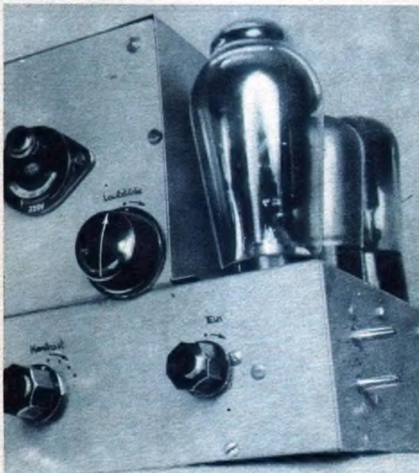
Wenn wir wie hier auf den Verstärker blicken, so sehen wir oben auf der Mitte den Sicherungstüpfel, darunter rechts den Regler für die Lautstärke, wieder darunter in der Mitte den Regler für die Kontrastbemessung und rechts den Schalter. Auf der rechten Seite die Netzstecker, darüber die drei hintereinanderliegenden Röhren der rechten Seite.
