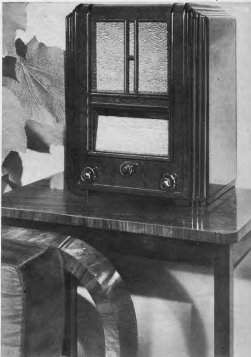
Der Zweikreis-Vierrohren-Batterie-Empfänger „Wismar“ der Fa. Körting, ein Gerät leistungsmäßig und äußerlich völlig ebenbürtig dem Netzempfänger. (Werkphoto)
