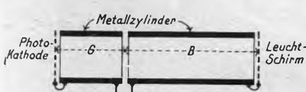
Abb. 1. Die einfachste Form einer Elektronen-Sammellinse besteht aus zwei Metallzylindern.
