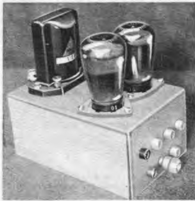
Oben: Abb. 4. Die einfache Schaltung des Mikrophon-Vorverstärkers.
