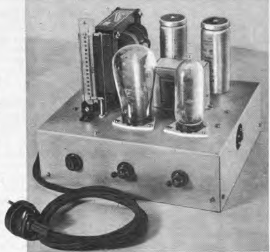
Das fertige Netzanflußgerät. Vorne Eisenwasserstofflampe, Gleichrichterröhre und Heizwiderstand. Rückwärts Netztrafo und Elektrolytblocks. Außerdem auf der vorderen Leiste die Schalter. Aufn. v. Verfallter.
