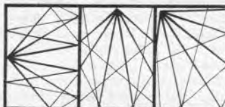
Wände, Fußboden und Decke werfen den Schall zurück. Weniger gefährliche Schallreflexionen bekommt man, wie das rechte Bild zeigt, wenn man den Lautsprecher in die Deckenecke setzt.
