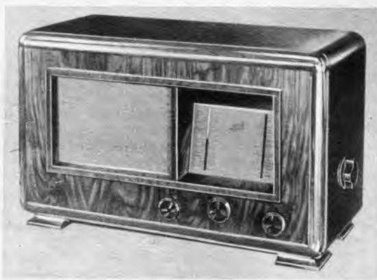
Ein Hochleistungs-Einkreisempfänger mit 2 Röhren. Das Gerät hat Tag- und Nacht-Umschalter. Werkaufnahme Körting-Radio.
