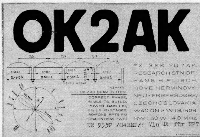
OK2AK, ein tschechischer KW-Amateur, verwendet mit großem Erfolg eine Richtstrahlantenne für 14 MHz und propagiert sie auf seiner Stationskarte.
