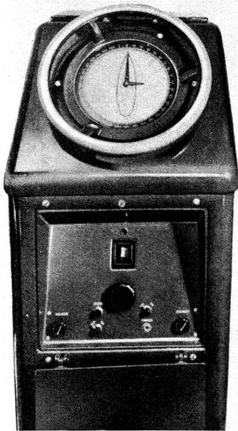
Der Funkpeiler mit der Peißkala. Mit ihm ist ein Tochterkompaß in der Weise verbunden, daß sich die Richtung des angepeilten Senders unmittelbar feststellen läßt. Unterhalb der Einstell- und Ablese-Vorrichtung der Empfänger mit seinen Bedienungsknöpfen.
