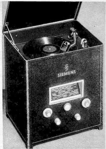
In diesem Gerät sind Empfänger, Plattenspieler, Mikrofonanschluß und Verstärker vereint. Diese und die auf der folgenden Seite gezeigten Ausführungen sind das Gegebene für den Gemeinschaftsempfang in mittleren und großen Betrieben. (Werkaufn. Siemens)
