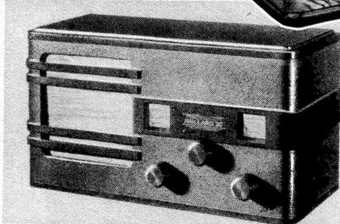
Der zweite Schweizer Volksempfänger, der „Paillard 20“, ein Superhet im Flachformat-Gehäuse.
