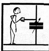
Links: Abb. 3. Der drehbare Teil des Kondensators ist hier nicht geerdet. Eine Berührung des Drehknopfes verursacht daher eine Kapazitätserhöhung.
