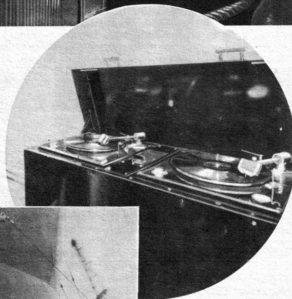
Im Verstärkerraum steht der Plattenspieltisch, der ver- schließbar ist und Überblen- dungen von der einen Schall- platte auf die andere erlaubt.
