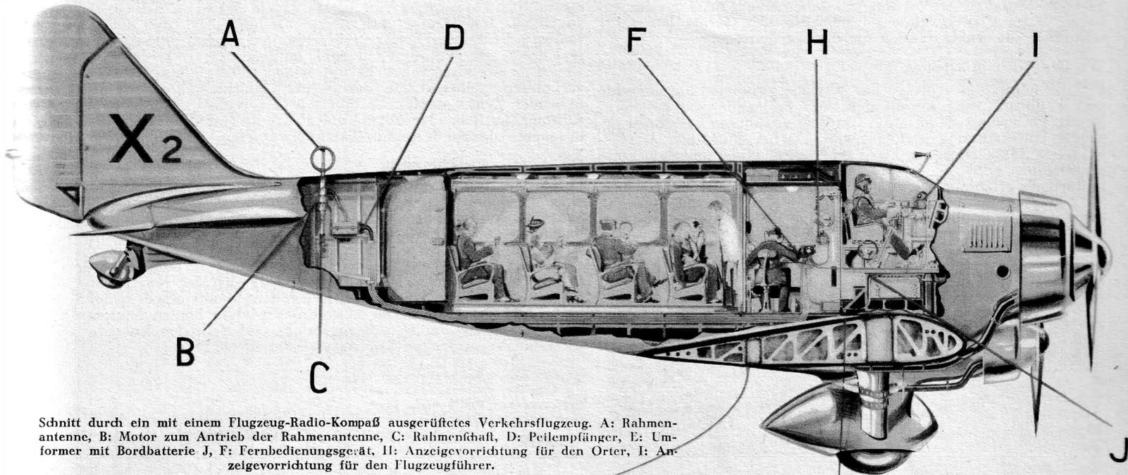
Schnitt durch ein mit einem Flugzeug-Radio-Kompaß ausgerüstetes Verkehrsflugzeug. A: Rahmenantenne, B: Motor zum Antrieb der Rahmenantenne, C: Rahmenschaft, D: Peilempfänger, E: Umformer mit Bordbatterie J, F: Fernbedienungsgerät, H: Anzeigevorrichtung für den Ort, I: Anzeigevorrichtung für den Flugzeugführer.
