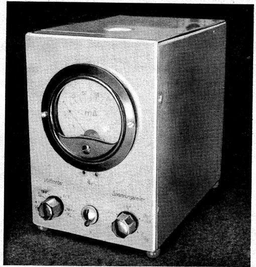
Das im Verstärker eingebaute Meßinstrument dient zur Messung von NF-Spannungen bis zu einer Frequenz von 10 000 Hertz und ist zur beliebigen freien Verwendung auch an Klemmen schaltbar.
