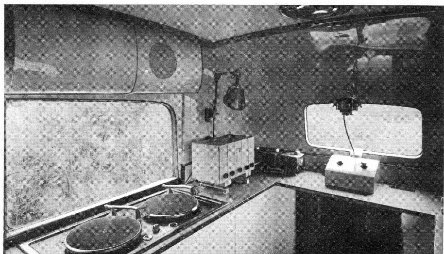
Übertragungsanlage auf Rädern: Blick in einen Lautsprecherwagen mit Plattenspieltischen, mit Arbeitsfrontempfänger, Bändchenmikrophon und Aussteuerungsgerät. Werkaufnahme Telefunken.
