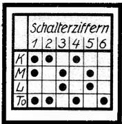
Links: Abb. 5. Schaltplan, in dem die geschlossenen Schalter durch schwarze Punkte veranschaulicht sind.
