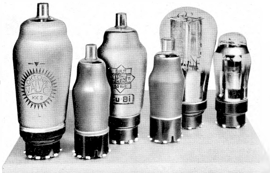
Der Sockel fast ebenso groß wie die Röhre — so ist es bei der „roten Serie“. Ein Größenvergleich zwischen entsprechenden Typen unserer heutigen Röhren und den Röhren der „roten Serie“.
