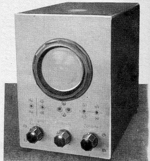
Das Ofzillofoskop. Ein Abdeckring aus Preßstoff umschließt die Röhre; darunter die Anschlußbuchsen und die Regler.
