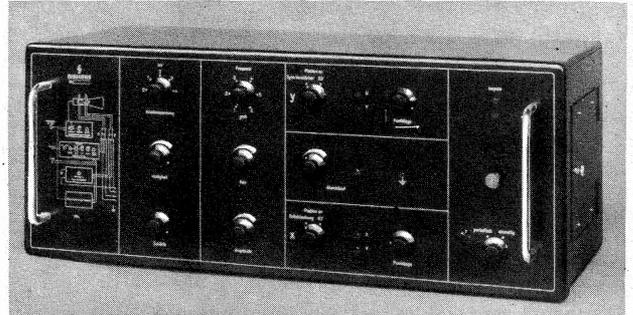
Die Frontansicht des tragbaren Elektronenstrahl-Oszillographen. Links auf der Frontplatte das grundsätzliche Schaltbild. Rechts auf der Seite die Klappe, hinter der sich der Schirm der Elektronenstrahlröhre befindet.
