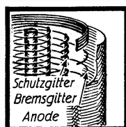
Links: Abb. 1. Blick in das System einer Fünfpol-Endröhre. Im Innern die Kathode, die vom Steuergitter umgeben ist. Das Steuergitter wieder umgeben vom Schutzgitter, zwischen Schutzgitter und Anode das Bremsgitter.
