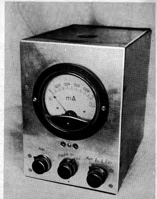
Wiederum in einem Normkasten, wie alle Geräte der Meßgeräteserie, sitzt auch das Röhrenvoltmeter und ist auf diese Weise vorzüglich untergebracht. Die Vorderseite trägt die Bedienungs- und Meßbereichsumhaltknöpfe und das Anzeigefinstrument. (Aufn. v. Verfasser)
