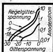
derart vorzunehmen, daß die beiden Spannungen — die Hilfsspannung (Oszillatorspannung) und die Empfangspannung — einander unbeeinflusst bleiben. Die Sechspolröhre macht das möglich. Sie hat zwei Steuergitter, weshalb man ihr die beiden Steuer-
