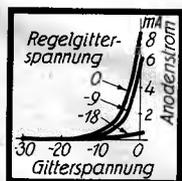
Links: Abb. 1. Die Anodenstrom-Gitterspannungskennlinien einer Sechspolröhre. Der Anodenstrom ist abhängig von der Spannung des ersten Steuergitters aufgetragen, das zweite Steuergitter besitzt eine feste Vorspannung.
