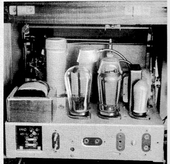
Die Innenansicht des Phono-Supers zeigt fast nur Röhren. Die Spulen sitzen unter dem Zwischenboden.
