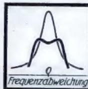
Links: Abb. 5. Resonanzkurve eines Bandfilters (dick) und im Vergleich dazu die Resonanzkurve eines Einzelkreises (dünn).
