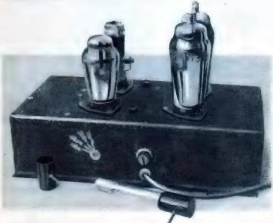
Die Rückseite der Endstufe mit dem Netzumschalter und der Anodensicherung. Im Vordergrund die Amplitudenröhre (eine der beiden Kapfen abgenommen).
