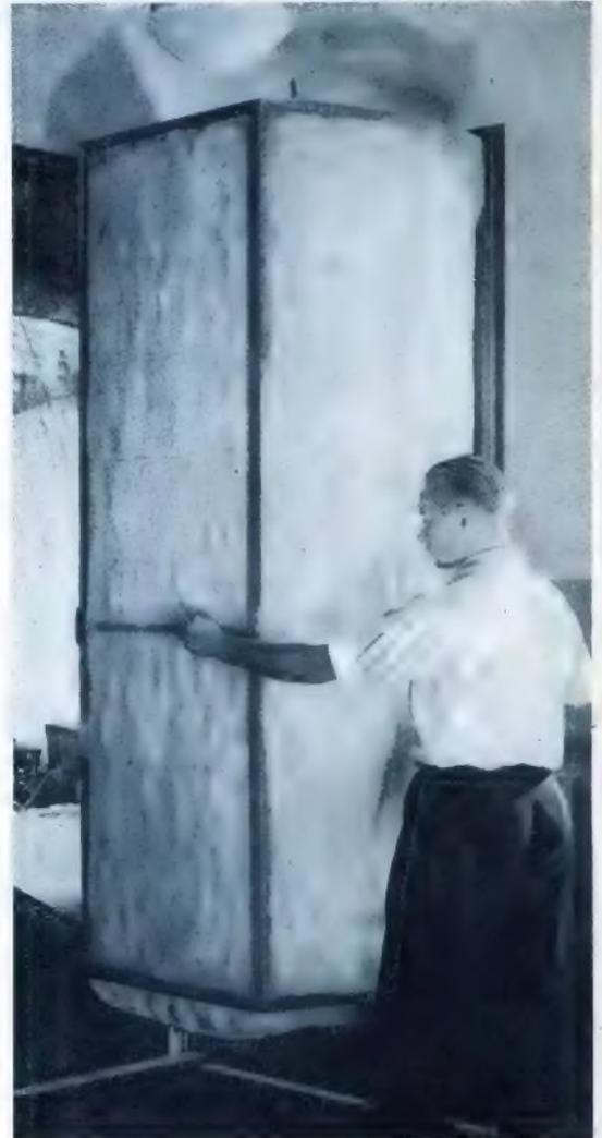
Rechts: Tür des schalldämpften Raumes im Zentrallaboratorium von Siemens & Halske. Das Bild läßt die Dicke der Wattedichten erkennen, die den ganzen Raum umgeben. Die Schallausbreitung in diesem Raum ist wie im Freien, da die Wände jeden Ton verschlucken.
