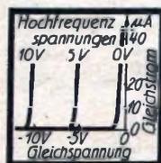
Links: Abb. 3. Die Kennlinien einer Gleichrichterröhre. Die Kennlinien gelten für sämtliche heute gebräuchlichen indirekt geheizten Zweipolröhren.
