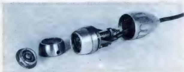
Das Kondensatormikrophon in seine Teile zerlegt. (Werkaufnahmen: Telefunken - 2)
