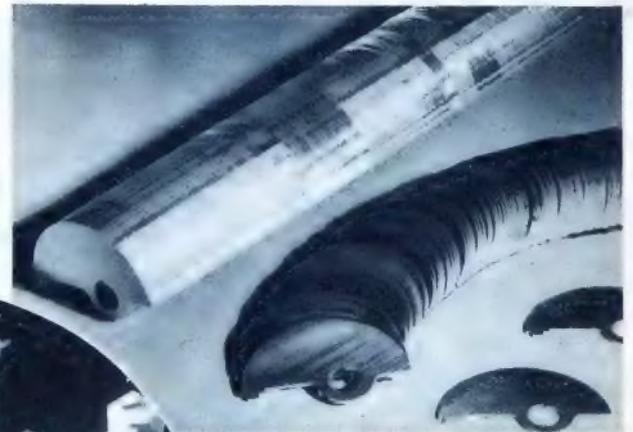
So genau und graffrei werden die Aluminium-Lamellen für die Drehkondensatoren gefanzt, daß sie den Eindruck eines Stangenprofils machen.
