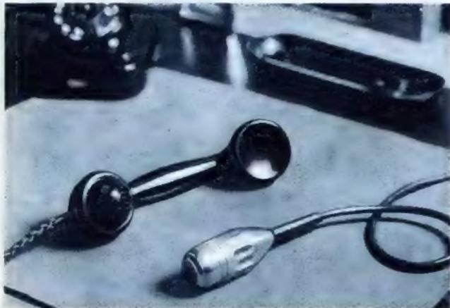
Das richtwirkungsfreie Kondensatormikrophon im Vergleich zu einem Fernsprechörer.
