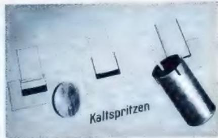
Der bei der Fertigung der Becher zur Anwendung kommende Kaltspritzvorgang.
