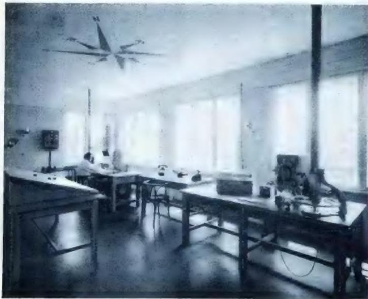
Im Peilerhaus von Buda-Örs. Vorn: normales Peilgerät mit Allwellen-Empfänger. Mitte: Telefonschiff und Kartenpult. Hinten: Impulspeilanlage.
