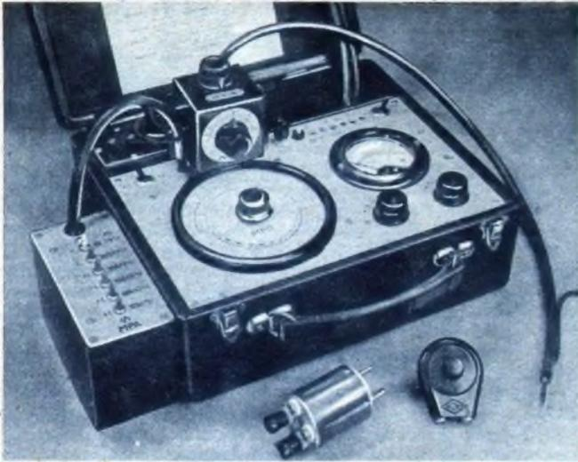
Das MPA-Gerät mit dem Druckknopfwähler und den anderen neuen Zusatzgeräten. (Ing. Walter Herterich)
