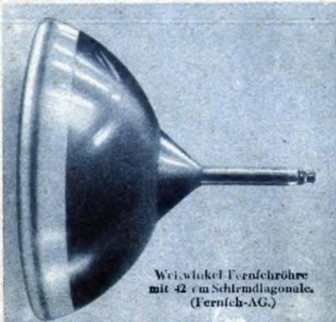
Weitwinkel Fernsehöhre mit 42 cm Schirmdiagonale. (Fernseh-AG.)
