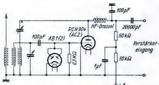
Bild 2. Eine empfehlenswerte Empfangsanordnung.
