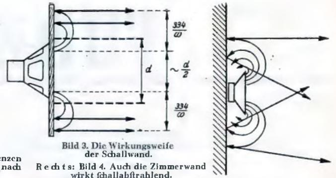
Bild 3. Die Wirkungsweise der Schallwand.
