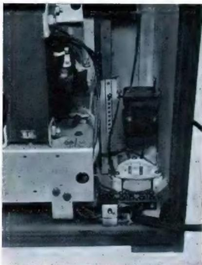
Bild 6. Zwischen Gestell und Gehäuse ist gerade Platz für die Unterbringung des Eisen-Wasserstoff-Widerstandes, der Drossel, des Vorwiderstandes für den Lautsprecher und der Klemmleiste.
