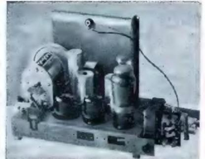
Der neue leichte Allstromsuper Sachsenwerk-Olympia 421 GWK macht von dem schon aus dem Vorjahr bekannten sehr stabilen Drehkondensator Gebrauch.
