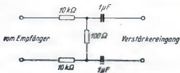
Bild 1. Die Anschaltung des Empfängers an den Schneideverstärker.
