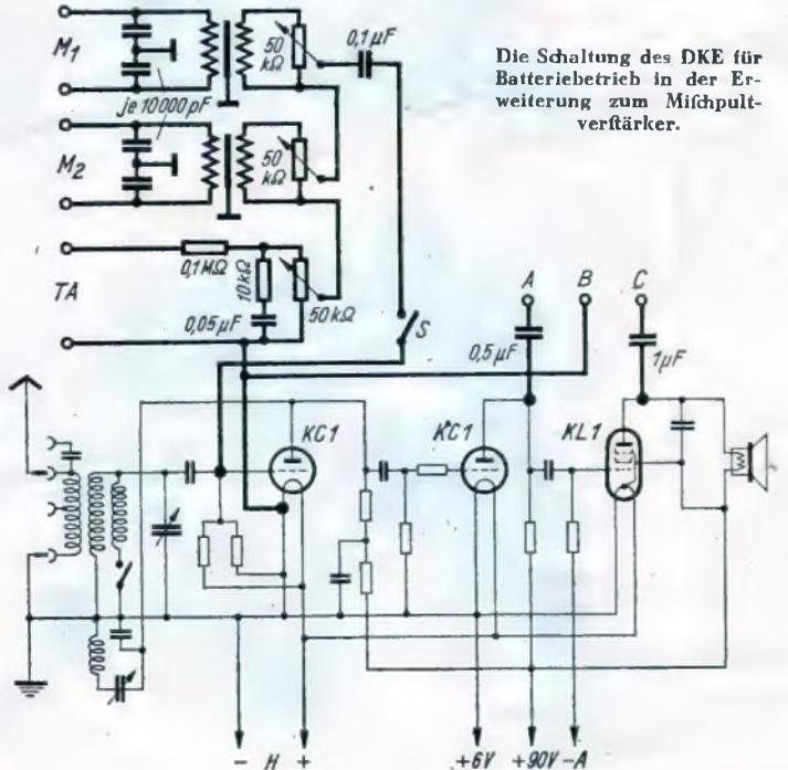
Die Schaltung des DKE für Batteriebetrieb in der Erweiterung zum Mischpultverstärker.
