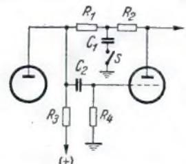
Bild 4. Eine weitere Schaltung, bei der der Sprache-Musik-Schalter die Gegenkopplung beeinflusst.
