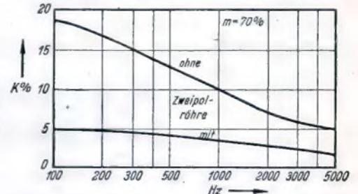
Bild 3. Die Klirrkurven für die Empfangsanordnung ohne und mit Zweipolröhre.
