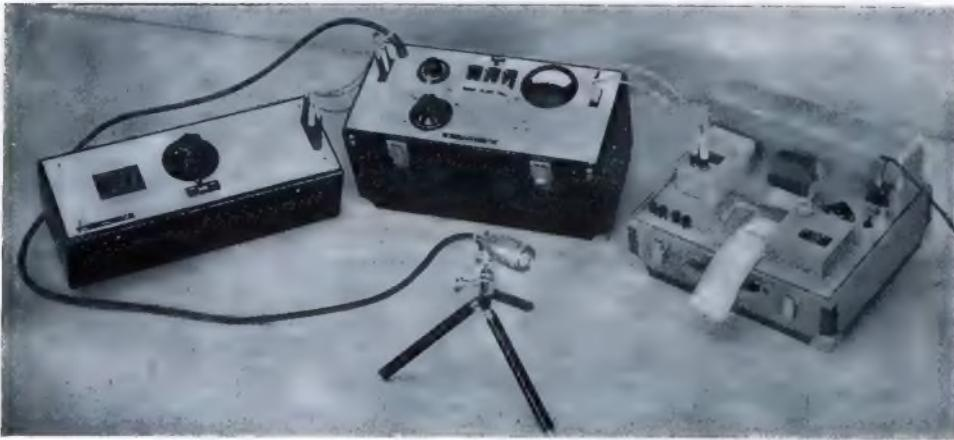
Bild 4. DIN-Lautstärkemesser mit Bandpaß und Schreibgerät.
