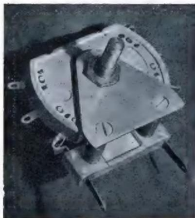
Die Anbringung des auf einer besonderen kleinen Grundplatte montierten Nockenschalters am Stufenschalter erfolgt in Einlochbefestigung.
