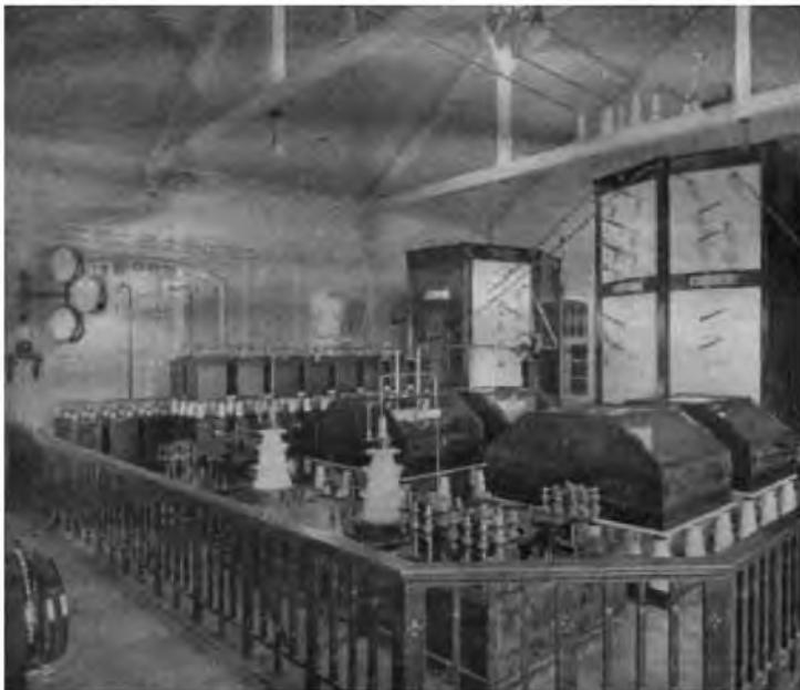
Mit der Einführung des Löschfunkens gewann Telefunken einen gewaltigen Vorsprung in der Funktechnik. Das Bild zeigt den damaligen Löschfunktensender (1916). — Oberes Bild: Die an der Heilandskirche in Sakrow bei Potsdam zur Erinnerung an die Errichtung der ersten deutschen Antennenanlage angebrachte Plakette (Archivbilder)
