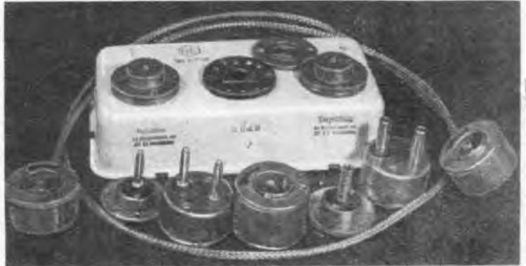
Bild 1. Vor dem Universal-Eichprüfer sind verschiedene Kupplungen gruppiert. Links sieht man die Reduktions-Universalkupplung in einpoliger und zweipoliger Ausführung mit Stecker, in der Mitte eine Zwischenkupplung, während sich rechts die Reduktions-Universalkupplungen mit Buchsen (ein- und zweipolig) anschließen. Das Ganze umrahmt ein mit Universalkupplung an beiden Enden ausgestattetes Abschirmkabel
