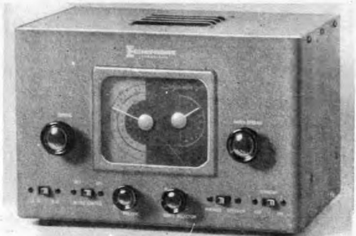
**Bild 1:** Vorderansicht des 6-Kreis-5-Röhrensupsers Echophone-„Commercial.“ Mitte: links Hauptabstimmung, rechts Bandabstimmung; unten, von links nach rechts: Telegrafie-Telefonieschalter  $S_2$ , Störbeseitiger  $S_3$ , Lautstärkeregelung mit Netzschalter  $S_1$  kombiniert, Wellenschalter, Umschalter für Kopfhörer- und Lautsprecherempfang, Sende-Empfangsschalter  $S_5$ . (Aufn.: FUNKSCHAU).
