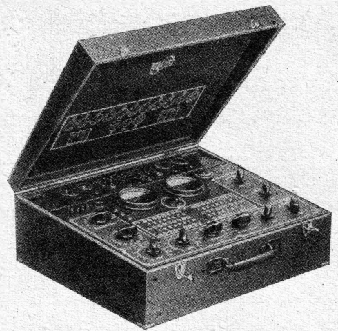
Bild 1. Ein Blick auf die Frontplatte des Röhrenmeßgerätes „Tubatest-M 1“ läßt die übersichtliche und zweckmäßige Anordnung der Bedienungorgane erkennen. In der Mitte befinden sich sechs Steckerleisten für die Spannungszuführung an die Röhrenelektroden, darüber sind Strom- und Spannungsmesser angeordnet. Ganz oben sieht man die Röhrenfassungsschleife mit den beiden Glühlampen L1 und L2. Unten haben links die Gitterspannungsregler mit der Vakuum-Prüfstaste und rechts die Anoden- und Schirmgitterspannungsregler Platz gefunden. In der Mitte sieht man den Prüfschalter und den Spannungsschalter. In der Mitte des Meßgerätes wurden auf der linken Seite Heizumschalter und Heizspannungsschalter angeordnet. Auf der rechten Seite finden sich Netzregler und das U g4 — Potentiometer.
