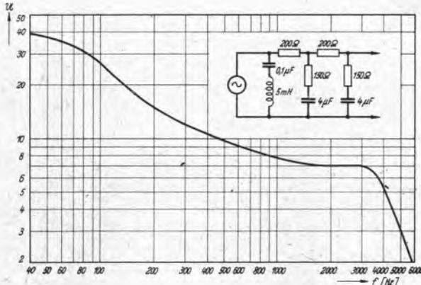
Bild 1. Frequenzverlauf eines Entzerrers mit Höhenresonanzkreis
