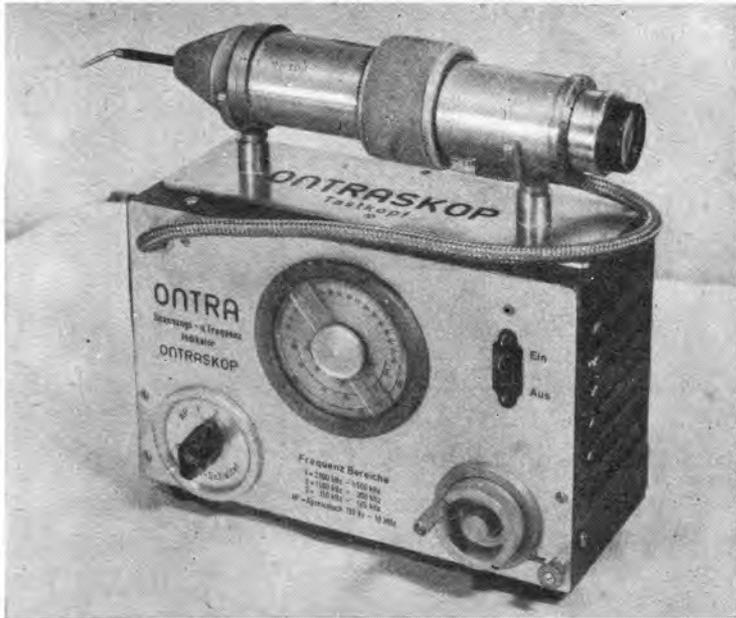
Bild 1. Spannungs- und Frequenz-Indikator „Ontraskop“
