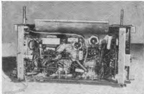
Bild 1. Die Verdrahtung des Standardsupers 1948 von unten gesehen
