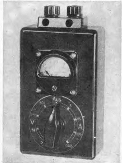
Bild 1. Neuer AEG-Vielfachprüfer für Gleich- und Wechselstrom
