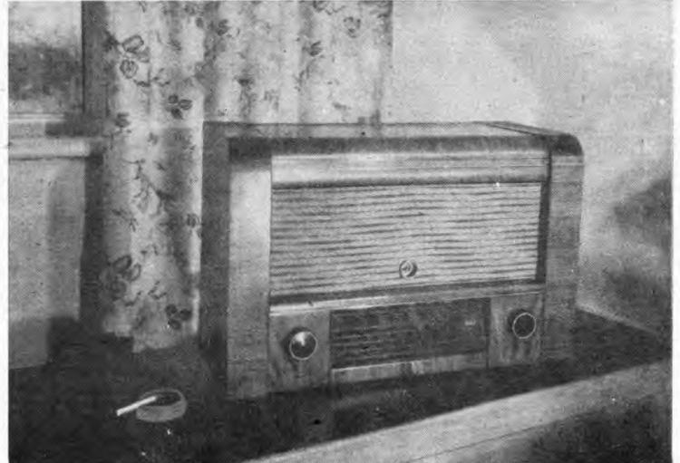
Bild 3. Der formschöne Großsuper 9 R81 von Stern-Radio mit mehreren KW-Bereichen und mit Magischem Auge
