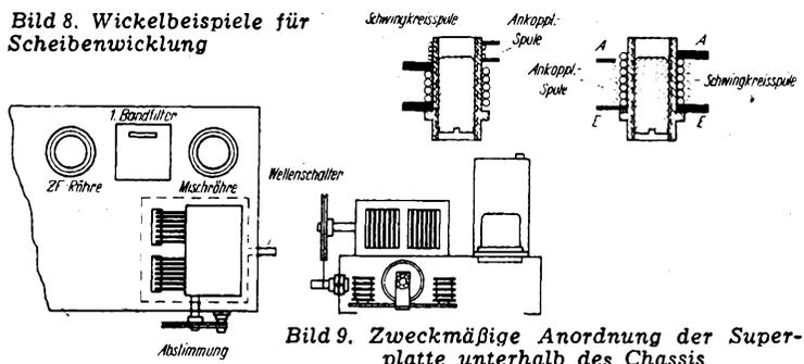
Bild 9. Zweckmäßige Anordnung der Superplatte unterhalb des Chassis
