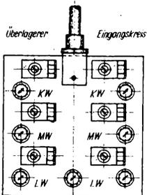
Bild 2. Anordnung der Spulen und Trimmer auf der Superplatte
