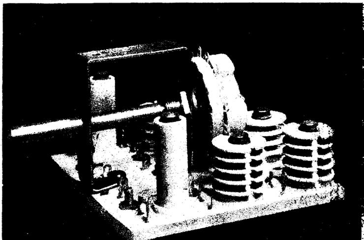
Bild 10. Superplatte, die einen besonders engen Zusammenbau von Drehkondensator und Mischröhre gestattet
