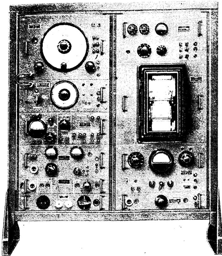
Bild 6. Gestellaufbau der automatischen Pegelschreibanlage (Links: Schwebungssummer, Steuerzusatz, Pegelgeber, Regelverstärker, Verteilerfeld und Netzfeld, rechts: Kraftverstärker, Schreibzusatz, Pegelempfänger und Vorverstärker)
