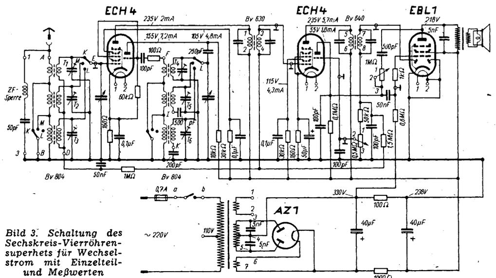
Bild 3. Schaltung des Sechskreis-Vierröhrensuperhets für Wechselstrom mit Einzelteil- und Meßwerten
