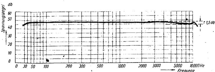
Bild 5. Frequenzkurve eines Kondensatormikrofons  $\pm 1,5 \text{ db}$  zwischen 30 und 11 500 Hz
