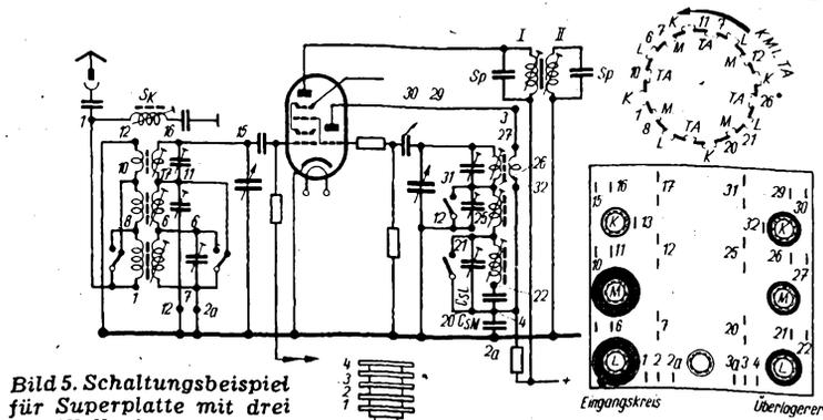
Bild 5. Schaltungsbeispiel für Superplatte mit drei Wellenbereichen
