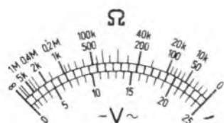
Bild 2. Ein besonderer Vorzug ist die für Gleich- und Wechselstrom geltende Skaleneinrichtung
