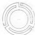
Bild 15. Dreiteilige Außenzentrierspinne geringen Durchmessers
