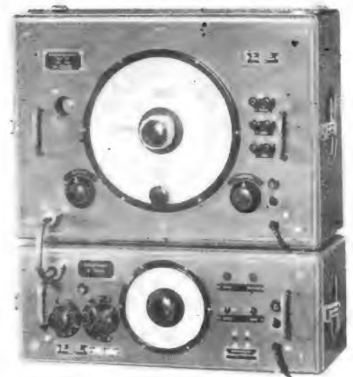
Bild 18. Einbereich-Schwebungssummer mit automatischem Steuerantrieb
