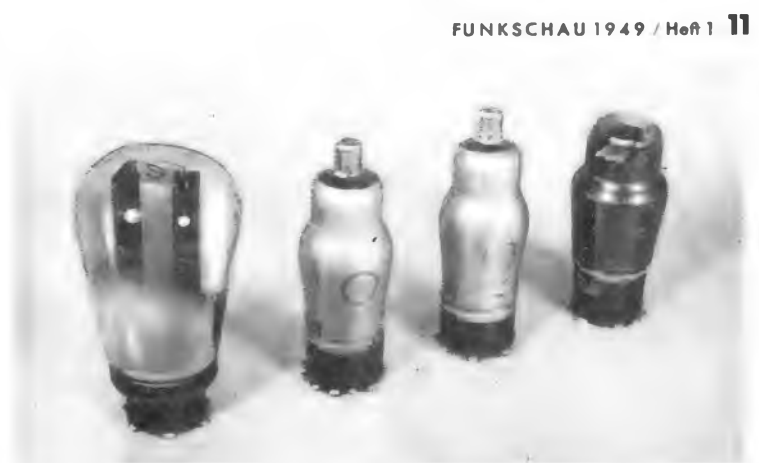
Bild 3. Die neuen Röhren UF 5, UF 6 und UL 2 im Größenvergleich zur Röhre AZ 11 (links)
