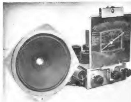
Bild 5. An der Frontseite sind die Bedienungs- knöpfe (Lautstärkeregler, Stationswähler, Wellenschalter) untergebracht
