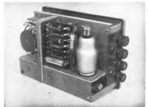
Bild 3. Das Röhrenvoltmeter RV 4 besitzt einen vorbildlich stabilen und übersichtlichen Aufbau
