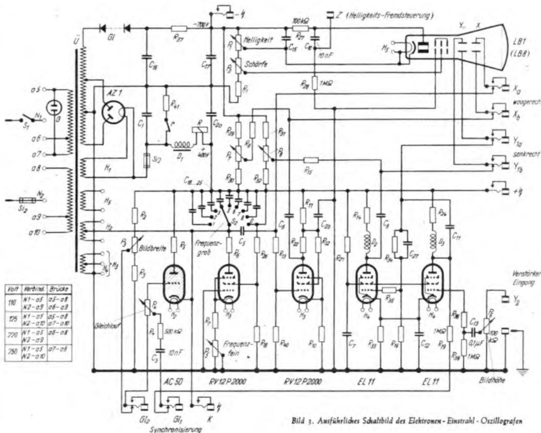
Bild 3. Ausführliches Schaltbild des Elektronen-Einstrahl-Oszillografen
