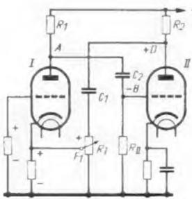
Bild 4. Multivibrator (Gegenkopplung)
