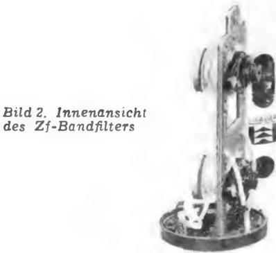
Bild 2. Innenansicht des Zf-Bandfilters
