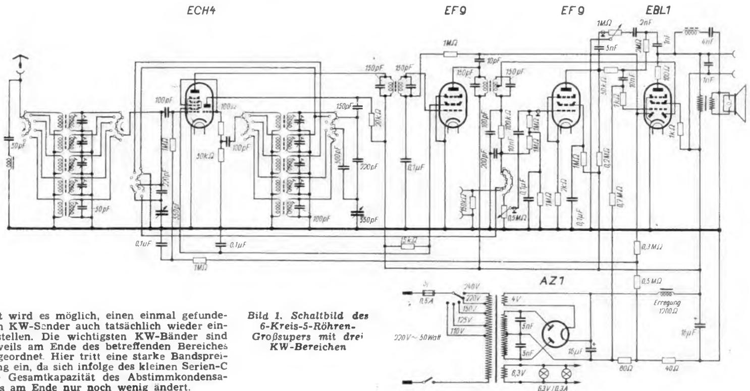
Bild 1. Schaltbild des 6-Kreis-5-Röhren- Großsupers mit drei KW-Bereichen
