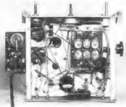
Bild 4. Blick in die Verdrahtung
