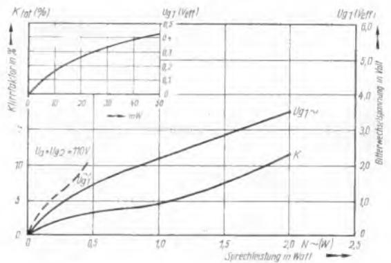
Bild 11. Aussteuerungskurven für die Endpentode UL 2
