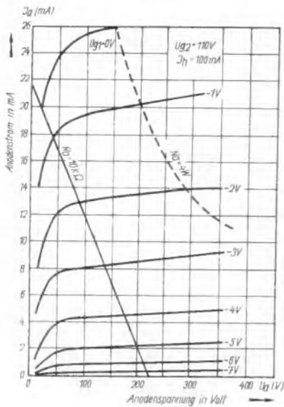
Bild 8. Anodenstrom der Endpentode UL 2 in Abhängigkeit von Anodenspannung für verschiedene negative Gittervorspannungen
