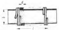
Bild 1. Wickelschema für Drahtwiderstände
