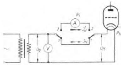
Bild 1. Heizstrommessung bei Beachtung des Strommesser-Innenwiderstandes  $R_i$
