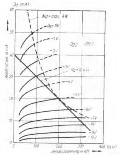
Bild 10. Ia/Ua-Kennlinien der Endröhre UL 2
