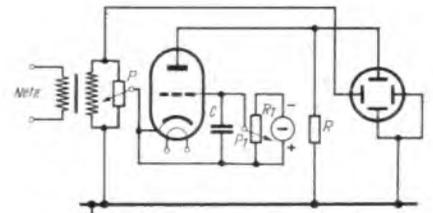
Bild 9. Grundätzliche Anordnung zur Darstellung von Anodenstrom-Anodenspannungskennlinien
