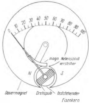
Bild 6. Drehspulmeßwerk (ohne Gegenkraftefedern)
