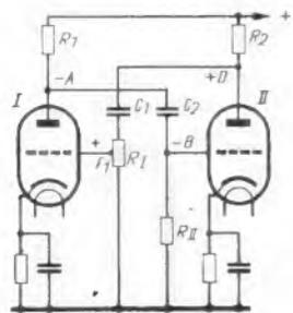
Bild 1. Multivibrator (Positive Rückkopplung)
