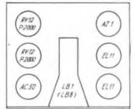
Bild 4. Anordnung der Röhren auf dem Gerätechassis
