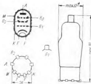
Bild 1. Systemanordnung, Sockelchaltung und Abmessungen der Röhre UF 5
