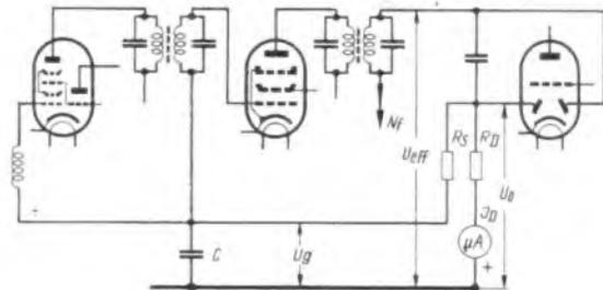
Bild 4. Messung der erzeugten Schwundregelspannung  $U_g$  mittels Strommessung.  $U_g$  = wirksame Regelspannung
