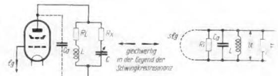
Bild 4. Anwendung von Bild 1 auf einen Hochfrequenzverstärker
