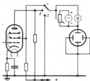
Bild 2. Messung von Gleichspannungen
