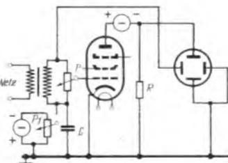
Bild 8. Grundätzliche Anordnung zur Darstellung von Anodenstrom-Gitterspannungslinien
