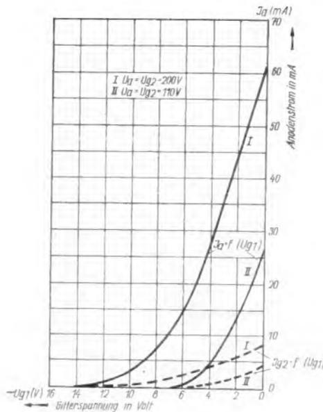
Bild 9. Anodenstrom der Endpentode UL 2 in Abhängigkeit von der Gittervorspannung
