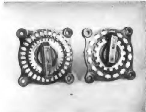
Bild 1. LTP-Stufenschalter
