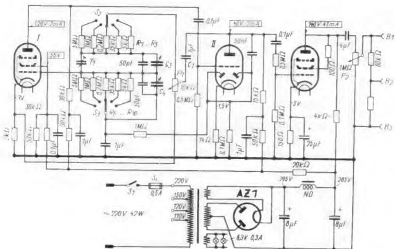
Bild 7. Schaltung des RC-Generators mit Wien-Brücke
