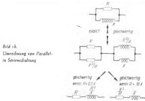
Bild 1b Umrechnung von Parallelschaltung in Serienschaltung
