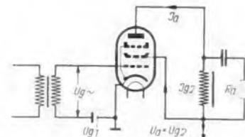
Bild 6. Messschaltung für die UL 2-Endpentode (Lia  $U_{R2} = 200$  V,  $I_a = 20$  mA,  $R_a = 10000$  Ohm,  $U_{g1} = -5$  V)
