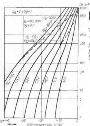
Bild 5. Gitterspannungs-Anodenstrom-Kennlinien der Röhre UF 5
