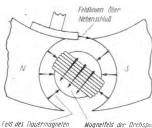
Bild 7. Drehspule vom vollen Nennstrom durchfließen
