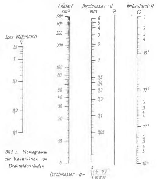
Bild 2. Nomogramm zur Konstruktion von Drahtwiderständen
