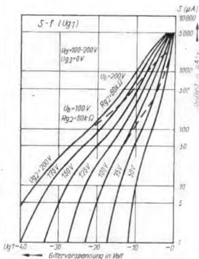
Bild 4. Steilheit in Abhängigkeit von der Gittervorspannung
