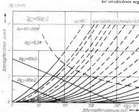
Bild 3. Schirmgitterstrom-Schirmgitterspannungs-Kennlinien der Regelpentode UF 5 bei verschiedenen negativen Gittervorspannungen
