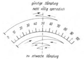
Bild 8. Zeigerschwingung eines günstig und ungünstig gedämpften Drehspulmeßwerkes
