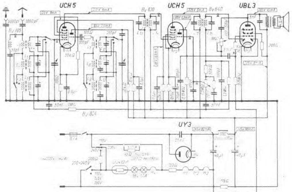
Bild 3. Schaltbild des 6-Kreis-4-Röhren-Allstromsuperhets „Atlanta GW“
