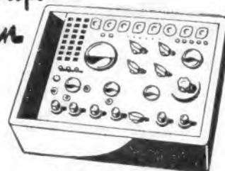
Ein Prüf- und Meßgerät für alle Röhren; auch für 12 P2000 und ähnliche. Einfache Bedienung, Vorprüfung und statische Messung. Betriebsspannungen regulierbar. / Aufnahmen von Kennlinien möglich.
