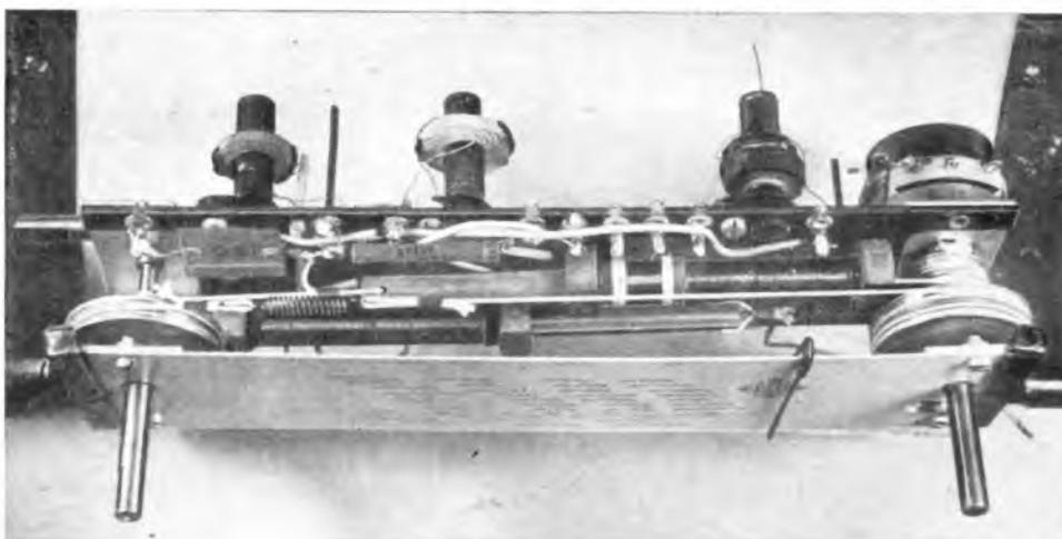
Bild 1. Das „Filius“-Abstimmaggregat enthält außer den Variometerspulen mit zugehörigem Seiltrieb, Zusatzspulen, Trimmer, Skala und Lautstärkeregler, der mit dem Netzschalter kombiniert ist
