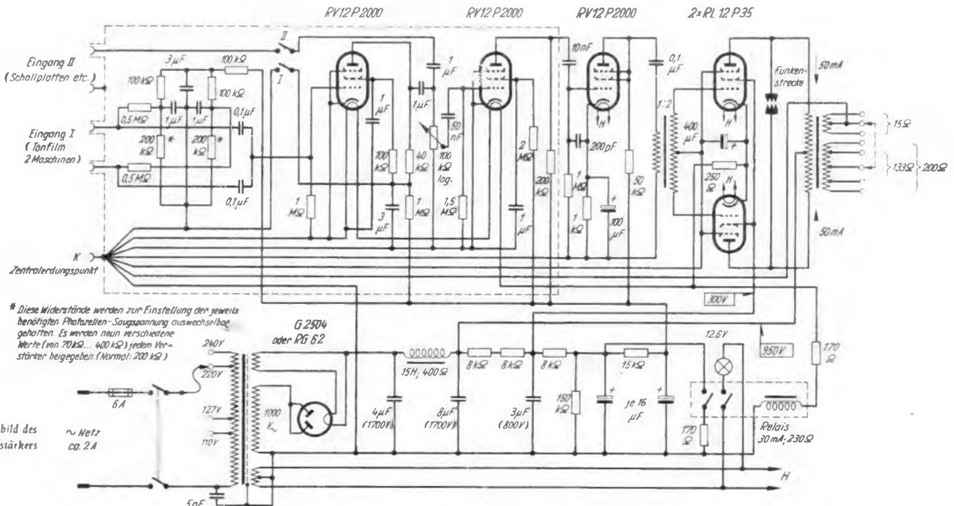
Bild 2. Schaltbild des 75-Watt-Verstärkers
