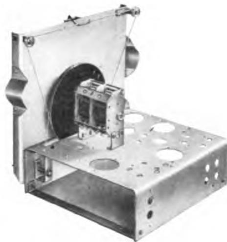
Bild 6. Empfängerchassis mit Zweifachkondensator und Skala
