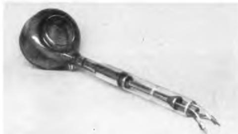
Bild 4. Fernseh-Projektionsröhre für Großbildempfang
