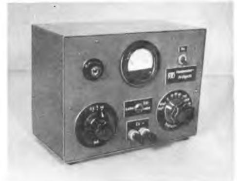
Bild 5. Kondensator-Prüfgerät, betriebsfertig
