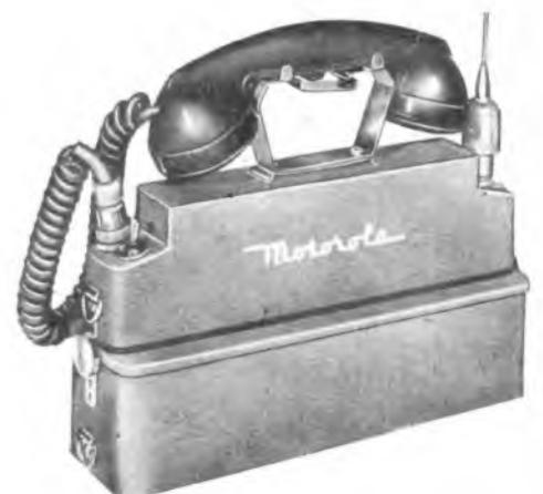
Bild 1. Nahsprechgerät mit Aufsteckantenne
