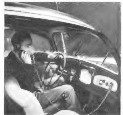
Bild 1. Der Polizeifunkwagen während des Betriebes. Während Sende- und Empfangsteil im Kofferraum untergebracht sind, befindet sich am Armaturenbrett fest eingebaut nur das kleine Bedienungsgerät mit dem Lautsprecher und dem Handmikrofon, mit dem der gesamte Funkverkehr ähnlich wie am Sprechapparat abgewickelt werden kann. Die Apparatur läßt sich von jedem Laien bedienen.
