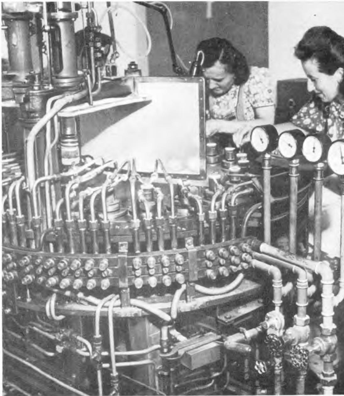
Die Radioröhren-Industrie ist bestrebt in der Röhrenherstellung von Zulieferwerken möglichst unabhängig zu sein. Dies läßt sich nur erreichen, wenn man fast alle Teile, die zum Aufbau einer Röhre erforderlich sind, im Werk selbst produziert. So werden im Telefunken-Röhrenwerk, Ulm, nicht nur die einzelnen Elektroden hergestellt und dann zu Systemen zusammengesetzt, sondern auch die Glasteile an großen Automaten gefertigt, wie das Bild erkennen läßt! (Aufnahme: H. Krause-Willenberg)
