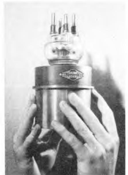
Bild 2. Luftgekühlte Sendetriode ATL 2—1 für 2 kW-Anodenverlustleistung
