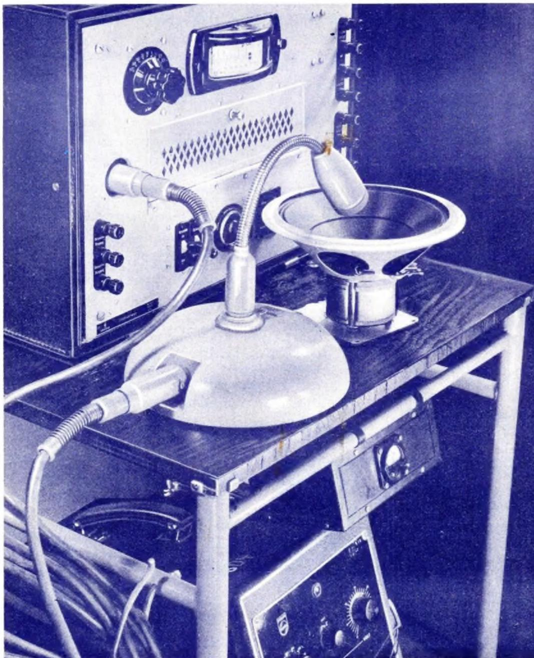
Zu den wichtigen Untersuchungen eines fortschrittlichen Industrielabors gehört die sorgfältige Überprüfung des in Rundfunkgeräten einzubauenden Lautsprechertyps. Das Titelbild zeigt uns Schalldruckmessungen an einem Lautsprecher-Chassis, das serienmäßig verwendet wird.
