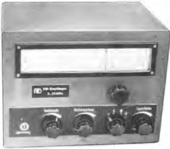
Bild 1. Hochwertiger Zweikreisler für Rundfunk und Telegrafie
