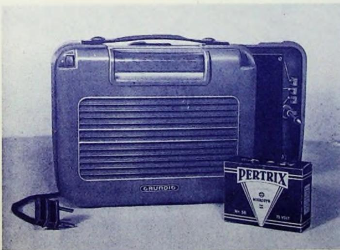
Bild 3. Grundig-Reisesuper 186 B/GW für Universalbetrieb
