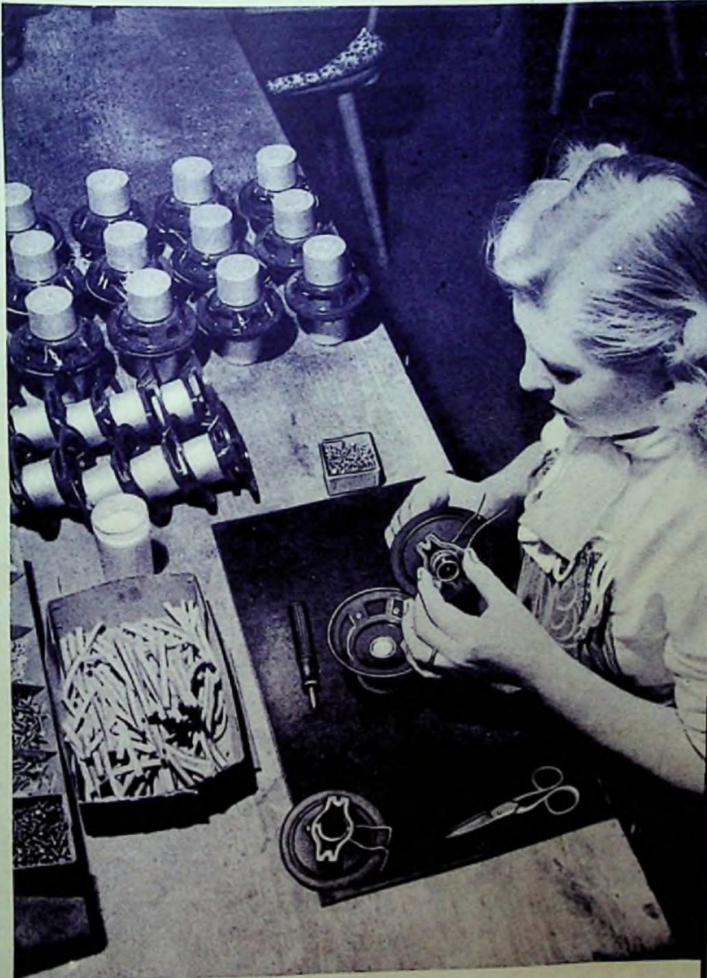
In Reisesuperhets werden hochwirksame permanentdynamische Lautsprecher eingebaut, die sich durch kleine Abmessungen und geringes Gewicht auszeichnen, trotzdem aber ein relativ breites Frequenzband wiederzugeben vermögen. Unser Bild zeigt einen Ausschnitt aus der Lautsprecherfertigung (Einsetzen der Lautsprechermembran mit Zentrierspinne)
