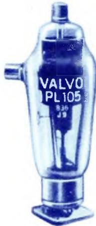
Die PL 105 ist eine quecksilberdampfgefüllte Thyatronröhre, die speziell für den industriellen Einsatz entwickelt wurde. Große Betriebssicherheit, hohe Lebensdauer und robuste Konstruktion sind daher ihre Hauptmerkmale. Ein weites Anwendungsgebiet findet diese Röhre in elektronischen Motorsteuerungsanlagen, Beleuchtungsregelgeräten und sonstigen automatisch oder halbautomatisch arbeitenden Anlagen zur Regelung von Temperatur, Druck, Geschwindigkeit, Drehzahl usw. —
