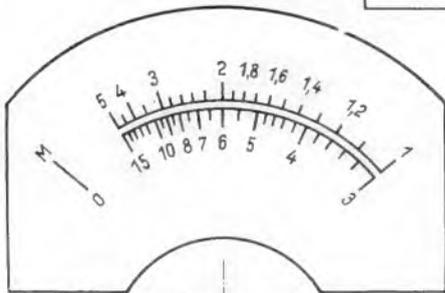
Wählt man z. B.  $R'_x \text{ min} = 10 \text{ k}\Omega$ , so ergibt sich für eine Frequenz von 800 Hz eine erforderliche Selbstinduktion von rund 40 H. Den Bereich eines Strommessers zu 500 µA bei Vollausschlag kann man damit bis 100 µA herab gut ausnutzen. Mit  $U_1 = 5 \text{ V}$  und  $W_1/W_2 = 1$  erhält man dann einen R-Meßbereich von 10...50 kΩ.
