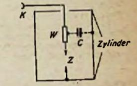
Bild 5. Ersatzschaltbild der im Motorzylinder eingebauten Entstörkerze
