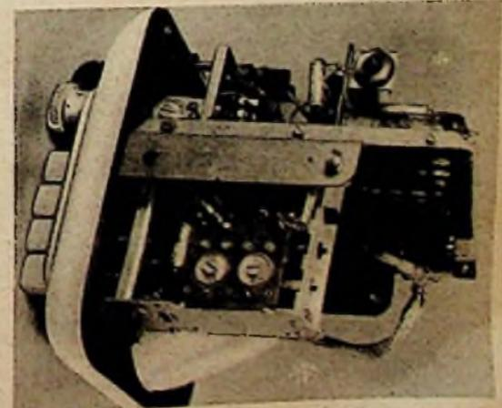
Bild 4. Chassisansicht des Telefunken-Autosuperherts I D 51 mit Drucktasten
