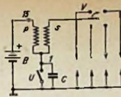
Bild 1. Prinzipschaltbild einer heute gebräuchlichen Batterie-Zündanlage für einen Vierzylindermotor, bestehend aus der Kraftwagenbatterie B, der Zündspule mit der Primärwicklung P und der Sekundärwicklung S, dem Unterbrecher U sowie dem Verteiler V für die vier Zündkerzen Z
