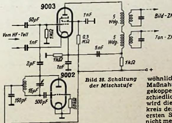
Bild 28. Schaltung der Mischstufe
