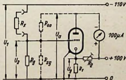
Bild 133. Isolationsmessung mittels Hilfe eines Röhrenvoltmeters
