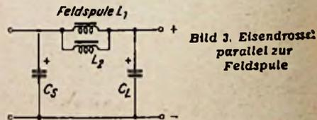
Bild 3. Eisendrossel parallel zur Feldspule
