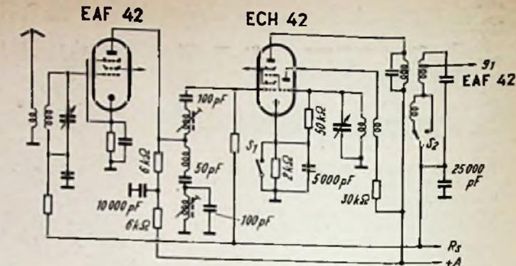
Bild 6. Empfindlichkeits- und Bandbreitenschalter im Telefunken-Super II A 51 (S<sub>1</sub> = Empfindlichkeitsschalter, S<sub>2</sub> = Bandbreitenschalter)
