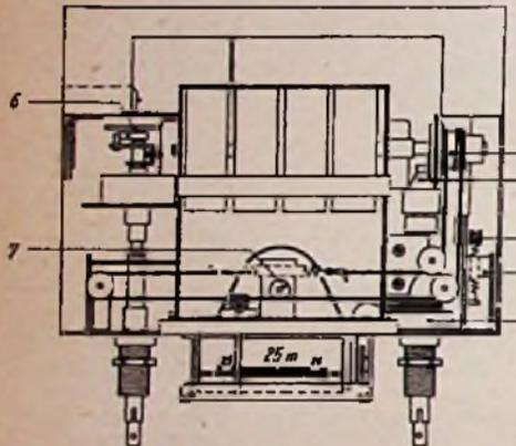
Chassisansicht des Philips Autosuperhets ND 593 V. Es bedeuten: 1 = Trommel für Antrieb der Induktivitätsabstimmung, 2 = Buchse mit Cummirolle für den Trommeltransport, 3 = Wellenschalter-Arretierung, 4 = Wellenschalterachse mit Zahnrad und Hebel, 5 = Trommel für den Skalenantrieb, 6 = Ein-Ausschalter, 7 = Halter für das Skalenlampchen
