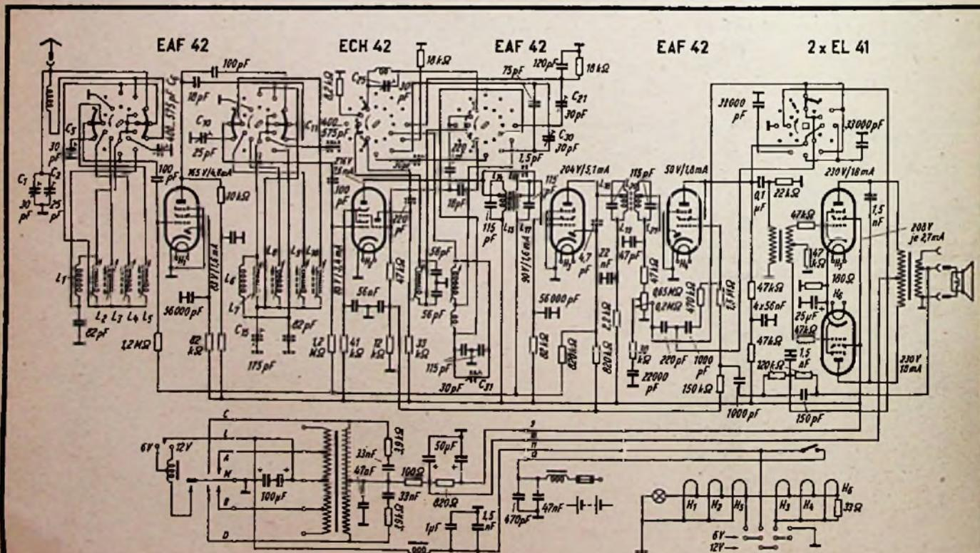
Service-Schaltbild des 7-Kreis-6-Röhren-Autosuperhets Philips ND 593 V mit Röhrenbetriebsdaten und Einzelteiwerten
