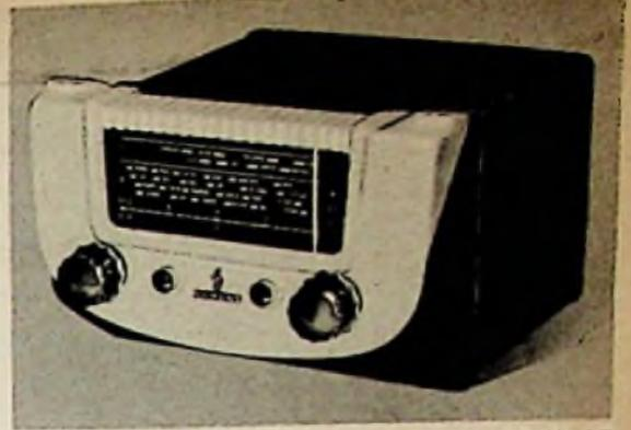
Bild 1. Empfangsteil des Siemens-Autosuper SB 101 AB
