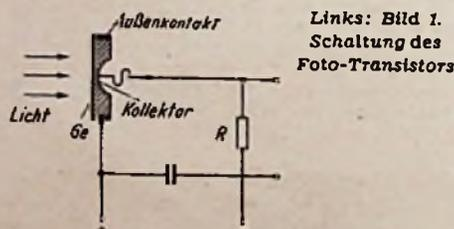
Links: Bild 1. Schaltung des Foto-Transistors
