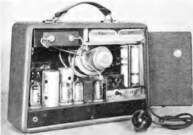
Rückansicht des betriebsfertigen Reise-superhets (Rückwand abgenommen). Die Batterien sind in zwei schmalen Fächern unterhalb des Traggriffes angeordnet. Das Gerät kann jetzt bei herausgezogener Netzschneur nach Betätigen des Stromart-Umschalters am Netz betrieben werden
