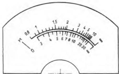
Bild 135. Skala des Isolationsmessers nach Bild 134
