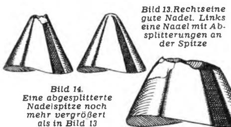
Bild 13. Rechts eine gute Nadel. Links eine Nadel mit Absplitterungen an der Spitze
