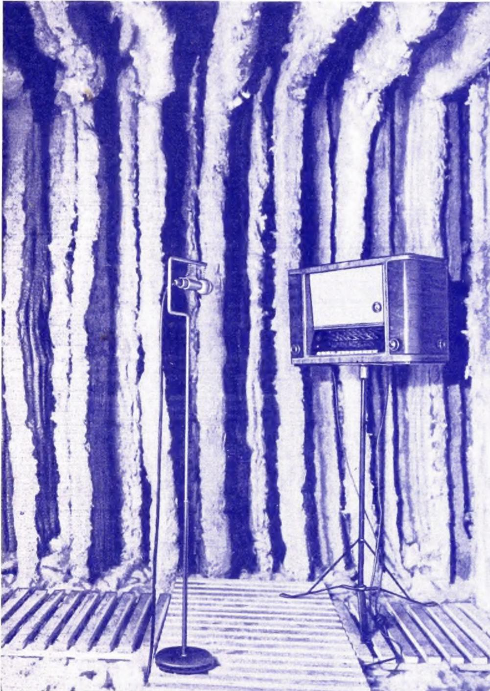
Bevor die Serienfertigung eines neu entwickelten Rundfunkempfängers beginnt, wird er in den Laboratorien sorgfältig geprüft und durchgemessen. Moderne Gerätefabriken besitzen eine Pegelschreiberanlage mit schalltotem Raum, die eine einwandfreie Aufnahme des Frequenzganges gestattet. Das Bild zeigt einen Spitzensuper im schalltoten Raum. Die abgestrahlten Schwingungen werden über ein Mikrofon dem Pegelschreiber zugeführt.
