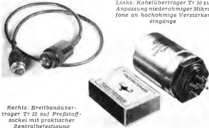
Links: Kabelübertrager Tr 50 zur Anpassung niederohmiger Mikrofone an hochohmige Verstärkereingänge
