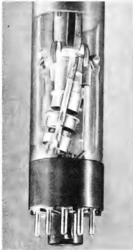
Bild 66. Ansicht des Strahlersystems der Fernsehrohr MW 22-16
