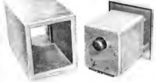
Rechts: Bild 2. Der Oszillator im Thermostat. Man sieht die durch Isolierleinen geschützte Heizwicklung, ausgeführt mit Chromnickelband, daneben das Wärmeschutzgehäuse, das mit porösen Holzfasern ausgefüllt ist
