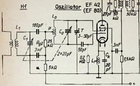
**Kompensation der dämpfenden Wirkung der Katodeninduktivität**
