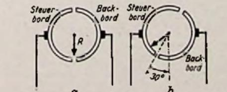
Bild 5. Teil einer Anordnung zur Steuerruder-Verstellung, die von dem Prinzip der automatischen Kurssteuerung Gebrauch macht.
