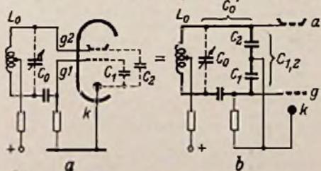
Bild 3. Oszillatorteil einer selbstoszillierenden Pentodenmischstufe
