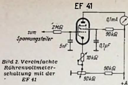
Bild 2. Vereinfachte Röhrevoltmeterschaltung mit der EF 41
