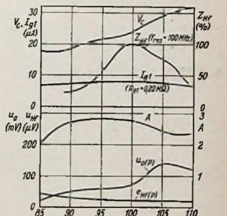
Bild 12. Abhängigkeit der Mischverstärkung  $V_c$ , der Aufschaukelung  $A$  durch die Antennenkopplung, der Oszillatorspannung  $u_0$  im Punkt  $P$  und der nutzbaren Hf-Eingangsspannung (Grenzempfindlichkeit für Störabstand 1:5) im Punkt  $P$  ( $e_{Hf}$ ) von der Abstimmfrequenz des Hf-Kreises, gemessen mit der Schaltung nach Bild 8 (EF 42). Außerdem ist die Resonanzkurve des Hf-Kreises für eine Abstimmfrequenz von  $100 \text{ MHz}$  eingezeichnet ( $Z_{HF}$ )
