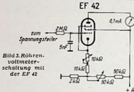
Bild 3. Röhrevoltmeterschaltung mit der EF 42
