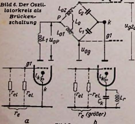
**Bild 7. Kompensation der dämpfenden Wirkung der Katodeninduktivität  $L_k$ . a) Prinzip, b) Entdämpfung durch eine Kapazität  $C_k$**
