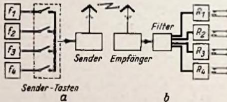
Bild 2. Wahlsystem unter Benutzung von Modulationstonen für die verschiedenen Steuerkanäle. a = Sender. b = Empfänger
