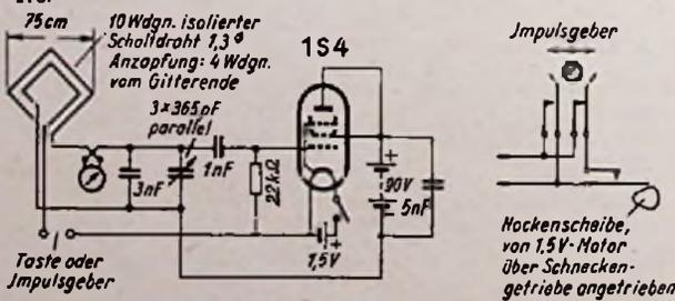
Unten: Bild 2. Schaltbild des Superhetempfängers. Sender und Empfänger machen je von einer Rahmenantenne Gebrauch
