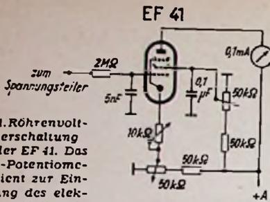
Bild 1. Röhrevoltmeterschaltung mit der EF 41. Das 50-kΩ-Potentiometer dient zur Einstellung des elektrischen Nullpunktes
