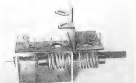
Bild 3. Das geöffnete Abstimmaggregat. Rechts Vorkreis A mit Antennenspule und Aluminium-Abstimmkern, links der Oszillator-Schwingkreis mit dem Hf-Eisenkern
