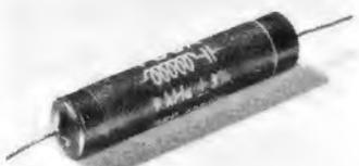
quenzgenauigkeit +3%, Betriebsspannung 500 V, Prüfspannung 1500 V. Die Spule konnte mit Hilfe eines Ferritkernes sehr klein gehalten werden. Form und Maße entsprechen denen eines Rollblockkondensators; wie dieser kann die 9-kHz-Sperre unmittelbar in die Verdrahtung eingelötet werden. Hersteller: Fuba Hans Kolbe & Co., Hildesheim.
