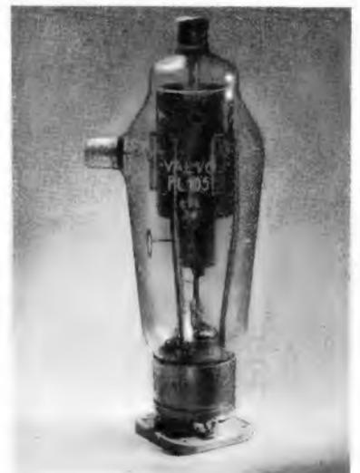
Bild 6. Thyatron oder Stromtor PL 105 für einen maximalen Anodenstrom von  $I = 6,4 A$  und einen maximalen Scheitelwert der Sperrspannung von  $\hat{U}_{\text{max}} = 250 V$ . Größte Länge 286 mm
