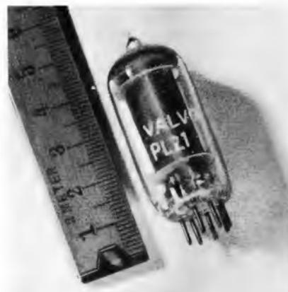
Bild 5. Thyatron<sup>2)</sup> oder Stromtor PL 21 für einen maximalen Anodenstrom (Mittelwert) von  $I = 0,1 A$  und einen maximalen Scheitelwert der Sperrspannung von  $\hat{U}_{\text{max}} = 500 V$ . Größte Länge 54 mm
