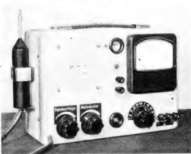
Oben: Außenansicht des betriebsfertigen Fehlersuchgerätes „Politest II“
