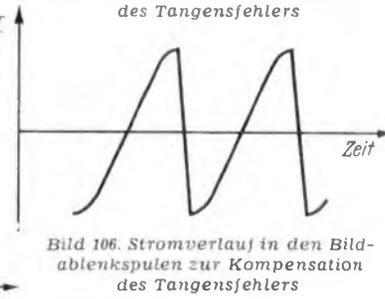
Bild 106. Stromverlauf in den Bildablenkspulen zur Kompensation des Tangensfehlers
