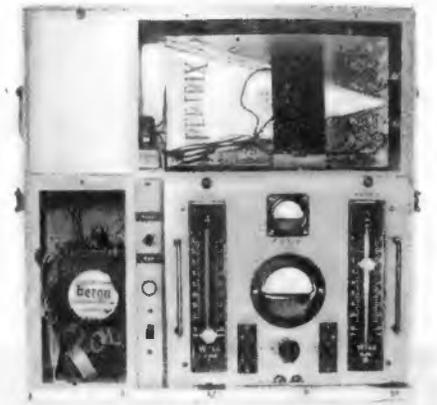
Bild 4. Verstärkeranlage F - V 34 K, Batterie- und Zubehörfach geöffnet
