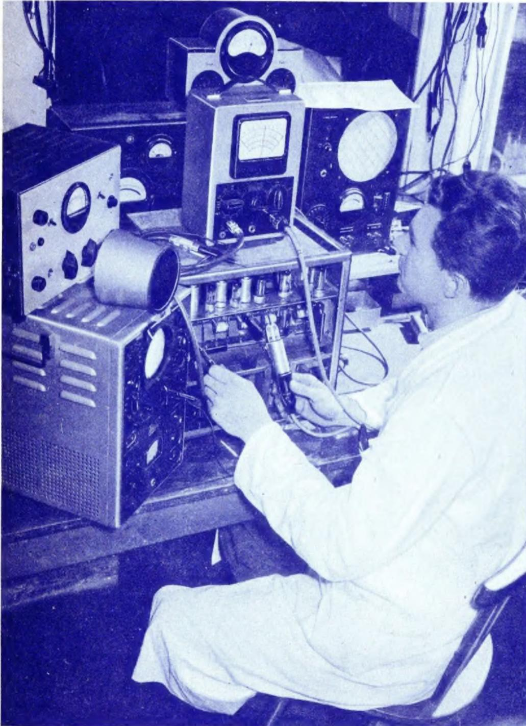
Die Fertigung von bisher 1 Million Rundfunkempfängern setzt sehr umfangreiche und hochwertige Meß- und Prüfgeräte voraus. Deshalb entstand im Rahmen der Grundig-Radio-Werke eine Fabrik für Meß- und Prüfeinrichtungen, die alljährlich für das eigene Werk mehrere tausend hochwertigster Meßsender, Oszillografen, Röhrenvoltmeter und dgl. baut und die heute auch den Markt beliefert. — Unser Bild zeigt den Abgleich eines großen Oszillografen für die Fertigungsprüfung von UKW- und Fernsehempfängern.
